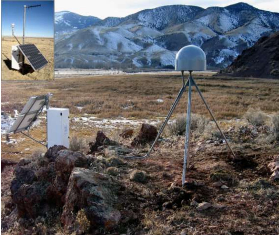
Figura 1. Estación PBO P009 cerca de Marysvale, Utah. Esta estación combina un monumento reforzado de perforación corta con un radome que alberga la antena geodésica (derecha) y el gabinete con el receptor y comunicación de datos y paneles solares (izquierda). Un monumento de estilo similar será utilizado en COCONet donde exista afloramiento rocoso competente. Otras opciones de monumento incluyen montaje en edificios y pilares de concreto donde no haya lecho de roca conveniente. El recuadro ilustra la instalación del paquete de meteorología.
